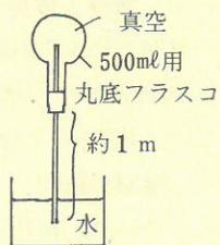
中に水を入れます。水を加熱すると何になりますか。そおー、水蒸気やな。じゃ、水蒸気を冷やすと?そおー水にもどるね。今、フラスコの中に水を入れて加熱すると、水は水蒸気になってフラスコの中の空気をどんどん追い出します。十分に加熱してからゴム栓をし、今度は冷してやります。そうすると水蒸気は水にもどるからフラスコ内はほぼ真空になるわけやな。
