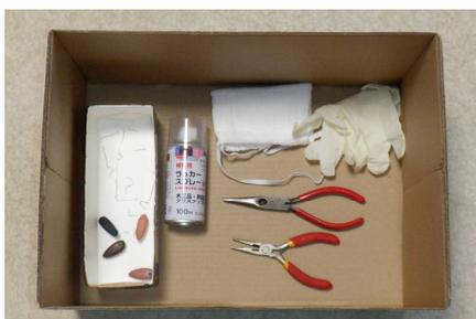
段ボールの中には、使い捨て手袋、マスク、ラジオペンチ、先曲がりペンチ、ラッカースプレー、乾燥台、その中にブランク4個が入っています。
